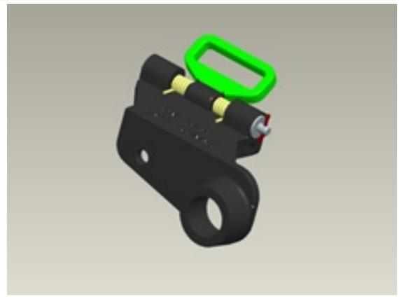
Faites pivoter le manche du levier de verrouillage pour vérifier que la patte d'accrochage émerge de la pièce coulée de retenue comme dans l'illustration. La came intégrée est conçue pour stopper la rotation quand la patte est dégagée (à environ 25 degrés).
