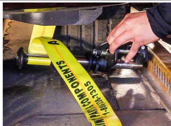
Une fois la fixation à encliquetage démontée, dégagez la fixation d'ancrage en soulevant la poignée du verrou à ressort jusqu'à ce que ledit verrou sorte du trou dans le rail.
