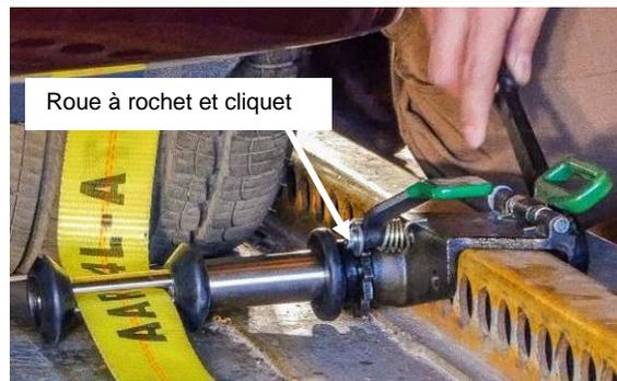
Serrez la sangle avec une clé à rochet manuelle avec carré conducteur de ½ po (1,27 cm) en appliquant un couple de 50 pi-lb (68 N.m) minimum. Évitez que le bout libre de la sangle ne s'enroule sur les bagues en polymère en le tirant de la main gauche.
