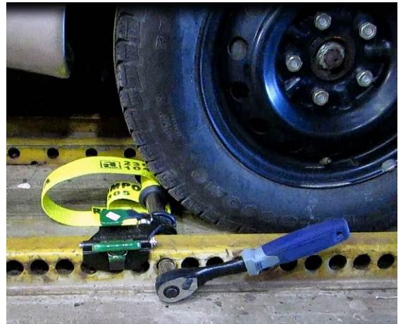
Une fois la sangle détachée de la bande de roulement, démontez la fixation à encliquetage en soulevant la poignée du verrou à ressort jusqu'à ce que ledit verrou sorte du trou dans le rail.
