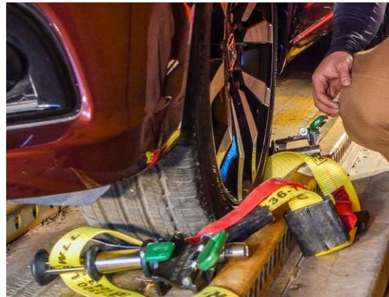
Tirez la sangle pour la tendre afin de faciliter le montage de la fixation à encliquetage.
