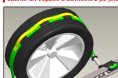
4. Tendez la sangle au-dessus du pneu et centrez les barres de façon à les assujettir à la bande de roulement. Éliminez toutes torsades pour que la sangle soit bien à plat, avec le texte imprimé vers le haut.
