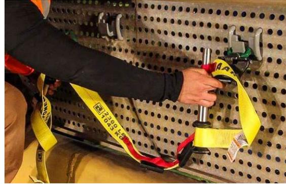
Déposez avec soin l'ensemble de fixation sur le pont du wagon, à côté du pneu à contrôler.
