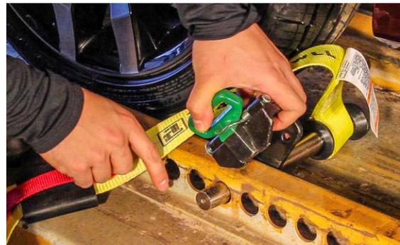
Une fois la fixation insérée, descendez la plaque de retenue sur le dessus le rail jusqu'à ce que le verrou à ressort s'engage dans le trou adjacent du rail.
