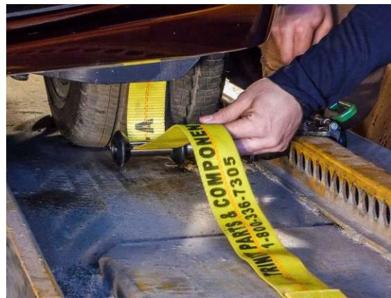
Déterminez dans quels trous du rail vous insérerez le bout du mandrin de la fixation de véhicule, de chaque côté du pneu à retenir.
