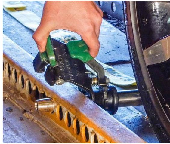
Continuez le mouvement utilisé pour désenclencher le verrou de la plaque de retenue pour faire pivoter la fixation vers le haut en direction de la bande de roulement, puis glissez la plaque de retenue pour l'extraire des trous dans le rail de calage.
