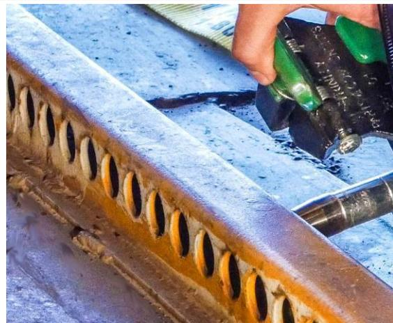
Idéalement, les sangles devraient être inclinées vers la bande de roulement ou, au maximum, être perpendiculaires au pont du wagon.
